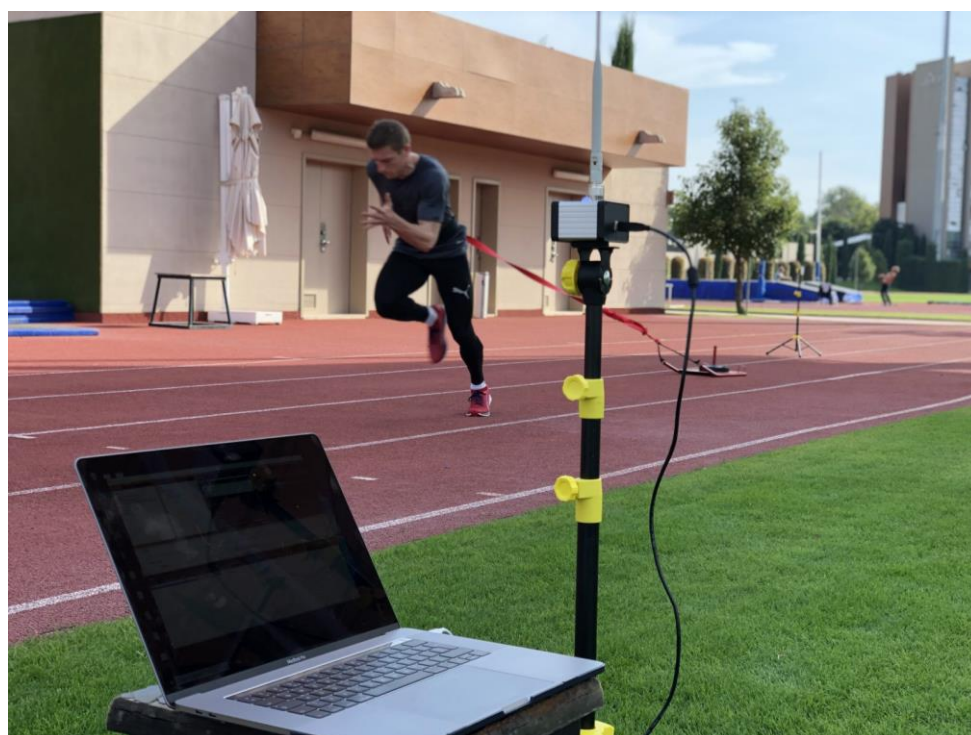
1.7-rasm. Tendo Sprint System –yugurish harakatlarini kompyuter, planshetda simsiz o‘lchash va tahlil qilish qurilmasi
